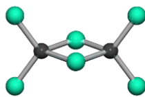
図 4 \text{Al}_2\text{Cl}_6 分子構造の模式図 (Al 原子 (4 配位) を黒い球、Cl 原子を緑の球で示している。)
